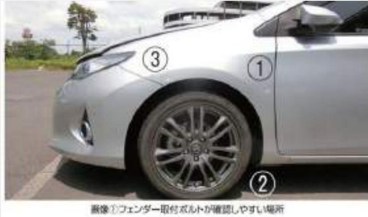
事故による損傷リスクが最も高いといわれるフロントエリア。骨格部位への衝撃波及を疑ううえでフロントフェンダーの確認は欠かすことができません。それゆえ検査員もフロントフェンダーの状態確認は念入りに行います。
