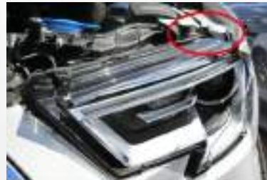
画像③通常より上に曲がった取付部(赤丸)
